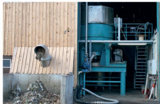
Zur Naßabscheidung von Störstoffen dient dieser Pulper.
